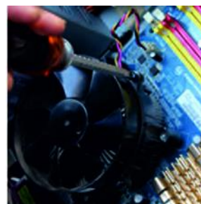
Fig. 43: Remove the system fan
