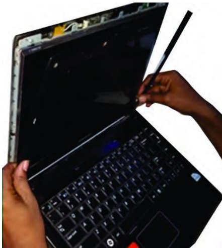
Fig. 78: Remove screen bezel
