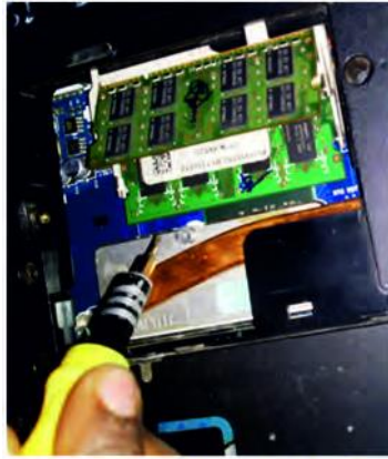
Fig. 65: Remove RAM memory modules
