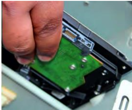
Fig. 12: Insert hard disk
